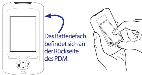
3. Setzen Sie zwei neue AAA-Alkalibatterien in das Batteriefach ein. Das Diagramm im Inneren des Batteriefachs zeigt die Richtung, in der die Batterien eingesetzt werden müssen.
