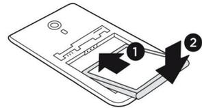
6. Setzen Sie den Akku ein. Drücken Sie das untere Ende des Akkus vorsichtig nach unten, bis der Akku einrastet.
