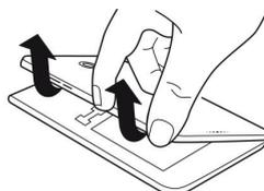
5. Orientare la nuova batteria in modo che le tre linguette dorate sulla batteria si allineino con i tre pin dorati nel vano batterie. I segni “-” e “+” sull’etichetta della batteria devono essere rivolti verso l’utente.
