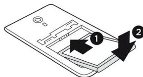
6. Far scorrere la batteria per inserirla correttamente. Spingere delicatamente la parte inferiore della batteria per inserirla.
