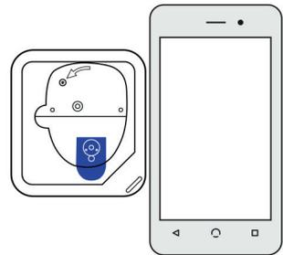
**Nota:** dopo l'abbinamento, il PDM deve essere sempre in grado di comunicare con un Pod distante fino a 1,5 m. A seconda della posizione, il PDM può essere in grado di comunicare con un Pod distante fino a 15 m.
