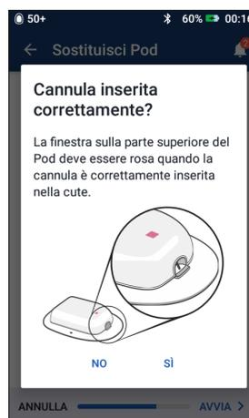
3.4 + Una volta inserita la cannula, verificare il corretto inserimento controllando che l'inserto scorrevole rosa sia visibile nella finestrella sulla parte superiore del Pod.
