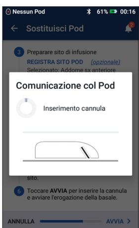
3.3 + Il Pod inserisce automaticamente la cannula ed eroga un bolo di priming per riempire la cannula con l'insulina
